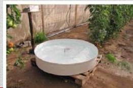
Figura 1. Bascula de evaporación montada bajo un invernadero de malla antiáfido. Km 19 valle de Azapa.
