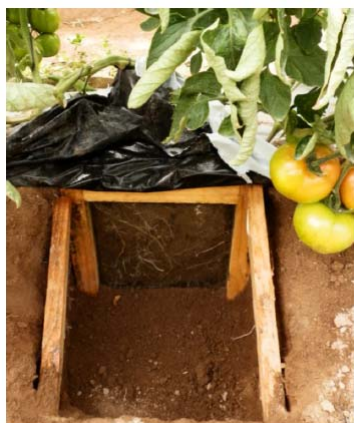
Fotografía 3. Rhizotron, en cultivo de tomate, para observar el comportamiento y estado de las raíces.
